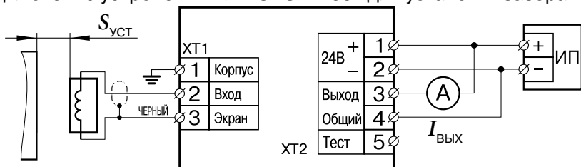
Рис. 6.2. Подключение устройств к ПЛП СИЭЛ–1662 для установки зазора.
