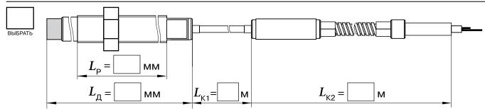
С1 – сальник для крепления проходной втулки: установочная резьба M20x1,5
