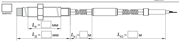
С1 – сальник для крепления проходной втулки: установочная резьба M20x1,5
