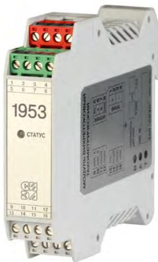
В комплекте с вихретоковым датчиком СИЭЛ–166Д-... модуль формирует измерительный канал частоты вращения и осуществляет передачу измеренного значения по цифровому последовательному интерфейсу.
